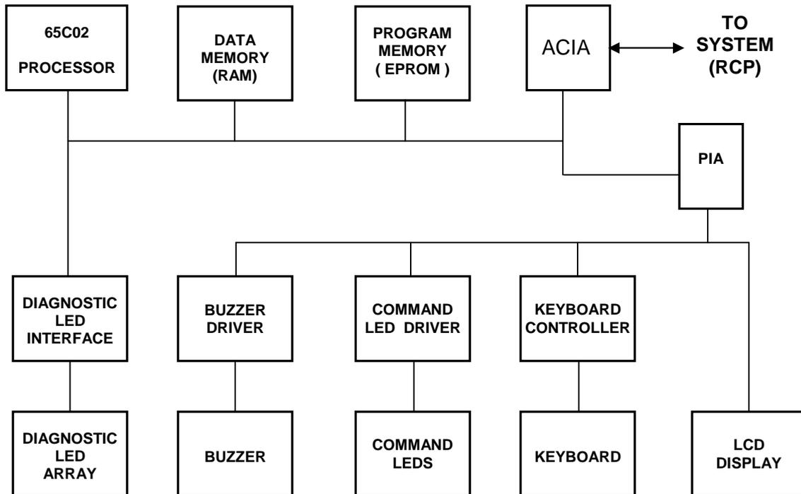
**Fig. 6.1 MAINTENANCE PANEL BLOCK DIAGRAM**
